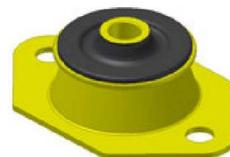
La particolare sezione sollecitata a taglio e compressione consente l'utilizzo di carichi importanti con buone deflessioni assiali. I supporti vengono montati con due rondelle di sicurezza per limitare i sovraccarichi. Sono particolarmente adatti all'utilizzo quali supporti motore e cabina.
