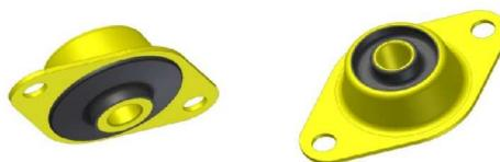
La particolare sezione sollecitata a taglio e compressione consente l'utilizzo di carichi importanti con buone deflessioni assiali. I supporti vengono montati con due rondelle di sicurezza per limitare i sovraccarichi. Sono particolarmente adatti all'utilizzo quali supporti motore e cabina.
