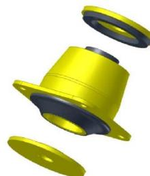
La particolare sezione sollecitata a taglio e compressione consente l'utilizzo di carichi importanti con buone deflessioni assiali. I supporti vengono montati con due rondelle di sicurezza per limitare i sovraccarichi. Sono particolarmente adatti all'utilizzo quali supporti motore e cabina.
